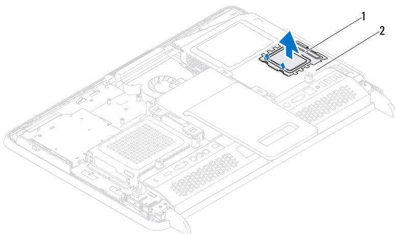
1 proteção do módulo de memória      2 proteção da placa de sistema
