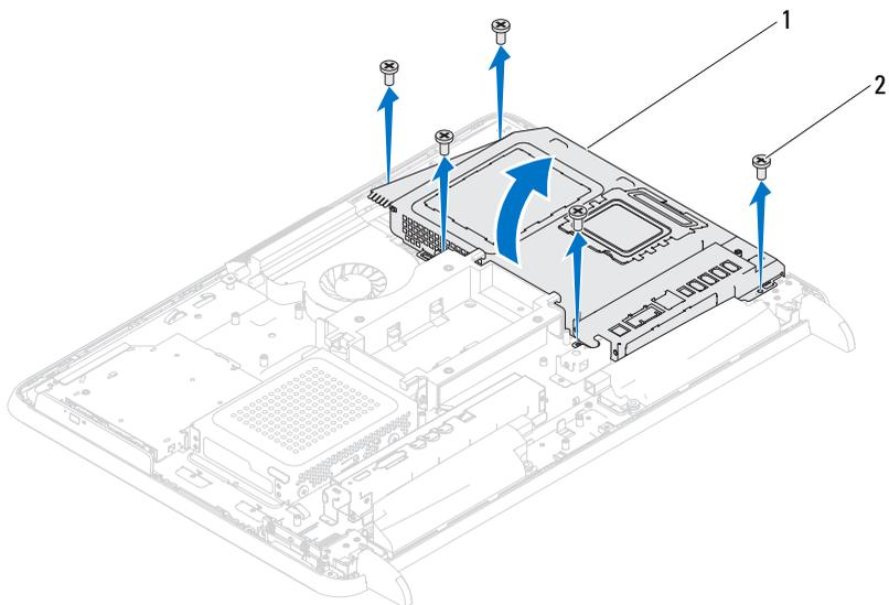
1 proteção da placa de sistema      2 parafusos (5)
